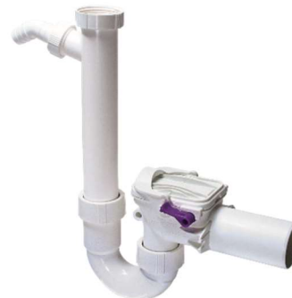
Abb.4 Mechanischer Rückstauverschluss, integriert in Ablaufgarnitur - nur bei fäkalienfreiem Abwasser zulässig
