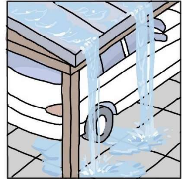
Carport ohne Ablauf/Weiterleitung
