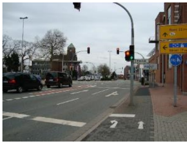
Direkte Radverkehrsführung, separate Signalisierung
