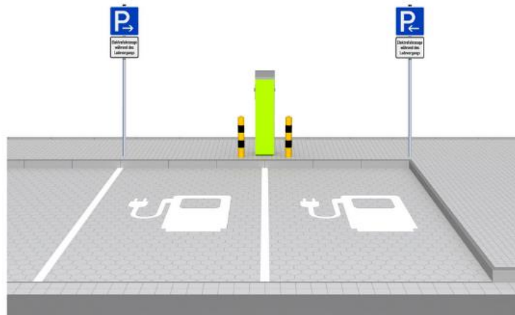
Abbildung 27: rechtssichere Beschilderung von Ladeinfrastruktur mit gut sichtbarer Bodenmarkierung (optional), Quelle: Katalog der Verkehrszeichen, Korsch 2022
